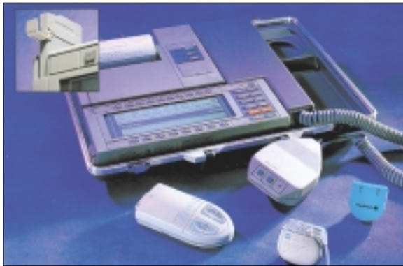
Figura 2: Components del sistema de SCS, Cònsola de programació per telemetria, Comandament del pacient i generador
